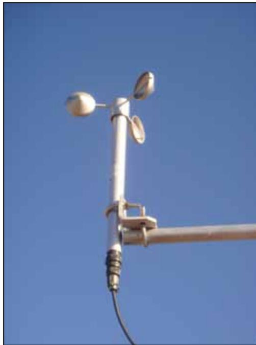
**Figure B.7. Anemometer.**
